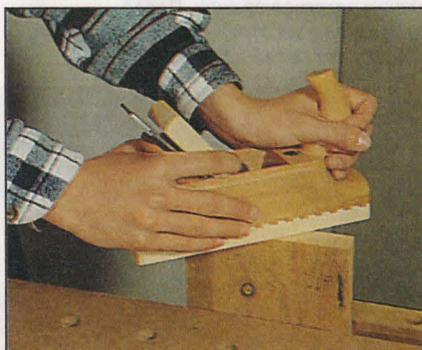
*Строгать торец заготовки будет значительно легче, если держать рубанок под углом к пластям заготовки.*
