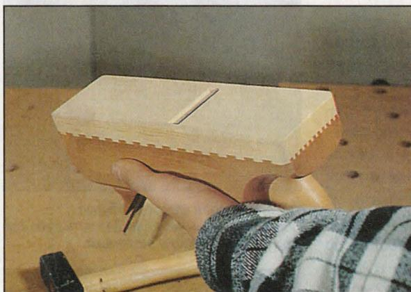
**Чтобы определить, правильно ли выставлен нож (его лезвие должно быть параллельно плоскости подошвы рубанка и слегка выступать над ней), надо просто перевернуть рубанок и оценить взаимную параллельность лезвия ножа и подошвы на глаз. Чтобы подрегулировать (если надо) положение ножа, освобождают клин, выставляют нож правильно и снова фиксируют его клином.**
