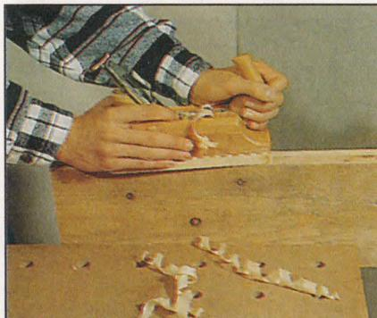
*Чтобы кромка не получилась закруглённой, рубанок нужно держать ровно, не наклоняя в какую-либо сторону.*
