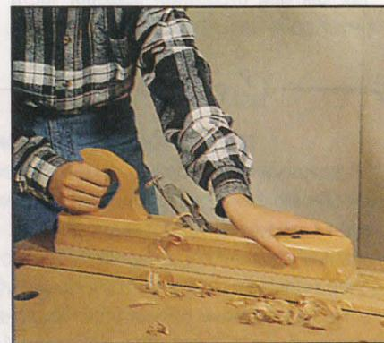
*При обработке заготовок большой длины лучше всего зарекомендовал себя фуганок, которым можно строгать даже навстречу волокнам.*
