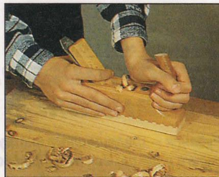
*Шерхебелем можно снять за один проход более толстый слой материала.*
