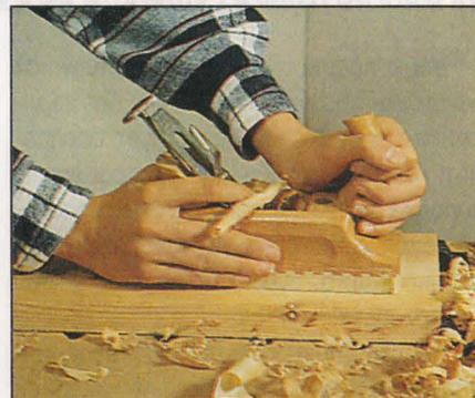
*Пласти заготовок небольшой длины получаются очень гладкими с шелковистым блеском уже после обработки одним только шлифтиком.*
