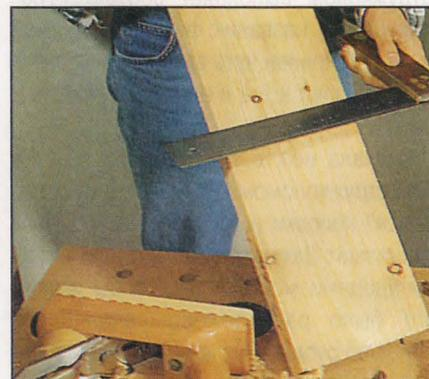
*При строгании пластей необходимо постоянно проверять стальным угольником их обрабатываемую поверхность.*
